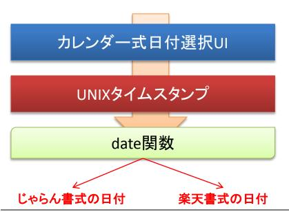
まず日付をUNIXタイムスタンプに変換します。 その上で、各APIで扱う形式の文字列として変 換します。
